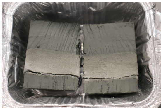
Delvis tørket prøve, viser godt det tykke sjiktet med silt
