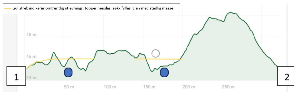
Figur 18: Viser høydeprofil med utjevningsindikator:
