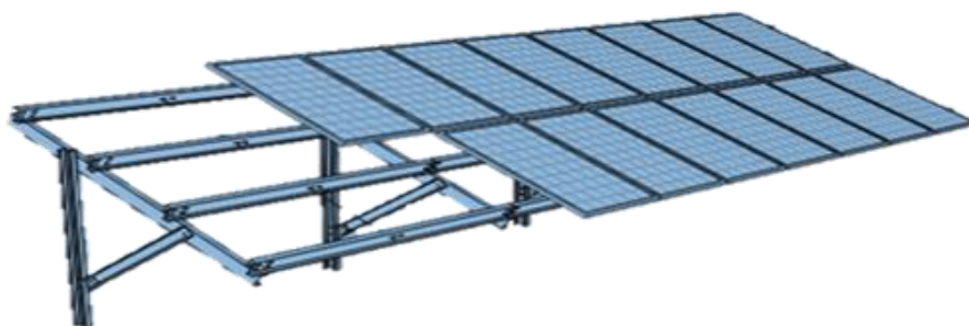
Figur 9 Fast montasjevinkel, 54 paneler per rad med to moduler montert med kortside mot kortside
