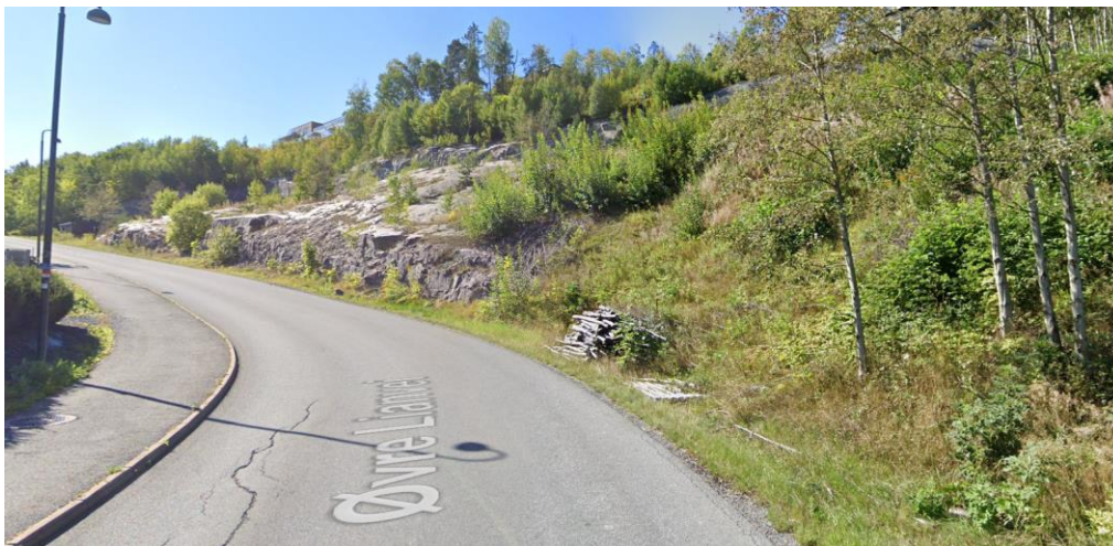
Figur 3-9: Eksempel på synlig berg i dagen ved Øvre Lianvei. Bildet er hentet fra Google Street view [8].
