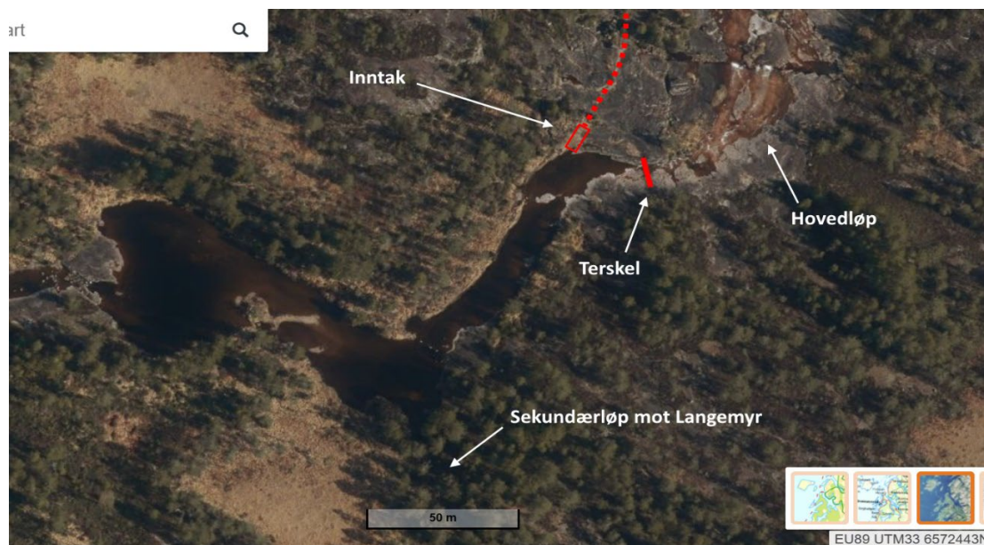
Fig.4: Plassering av terskel og inntakskum Alternativ I
