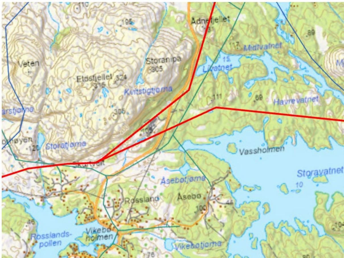
Figur 14: Viser muligheten for å flytte på alternativ 1.0 slik at kraftledningen kommer lenger unna motorsportanlegget
