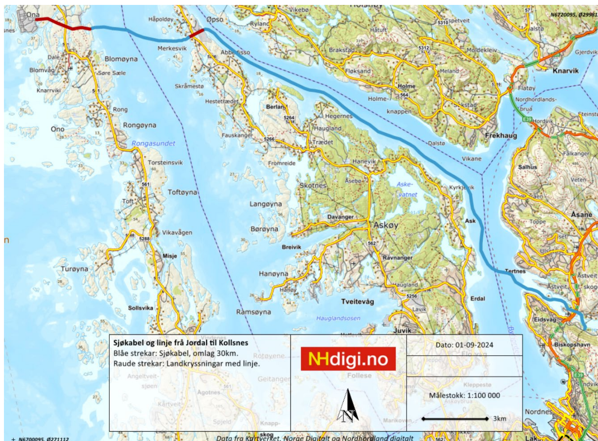
Figur 28: Naturvernforbundet sitt forslag til kabel- og luftledningstrase mellom Jordal og Øygarden stasjoner
