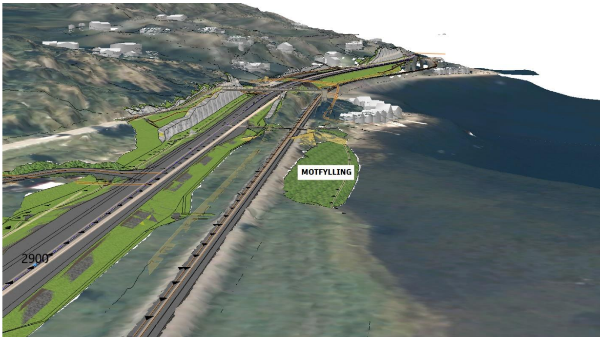
Figur 25: Motfylling for å øke stabiliteten for Nordlandsbanen
