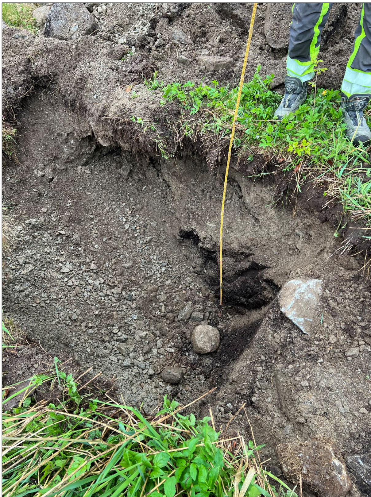
Figur 14: Foto fra gravepunkt 3. Myt/organisk materiale påtruffet i intervallet 0,9 – 1,2. Foto: SGC.
