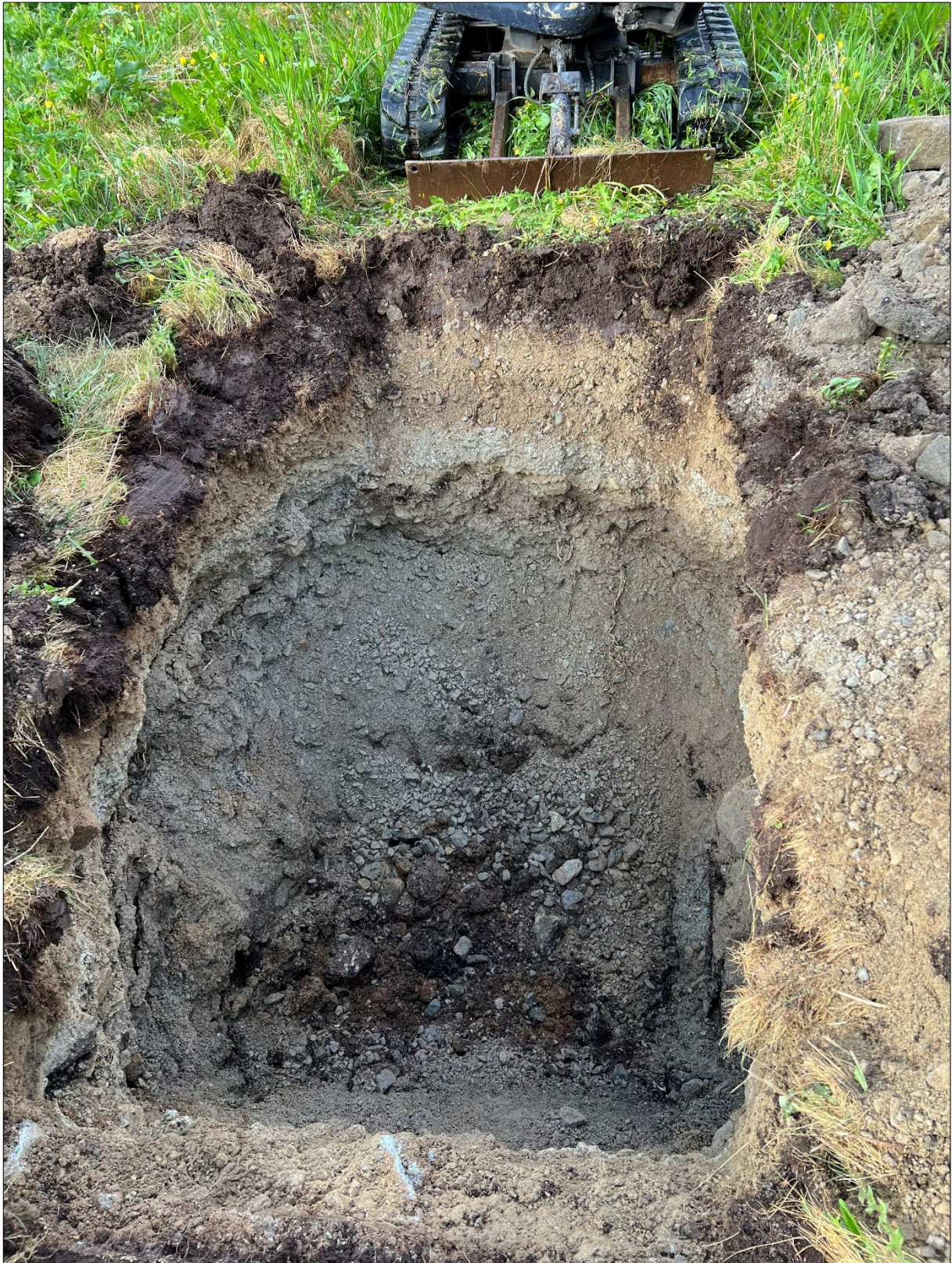
Figur 12: Foto fra gravepunkt 1. Myr/organisk materiale er synlig i bunn av sjakt ved 1,4 m dybde. Foto: SGC.
