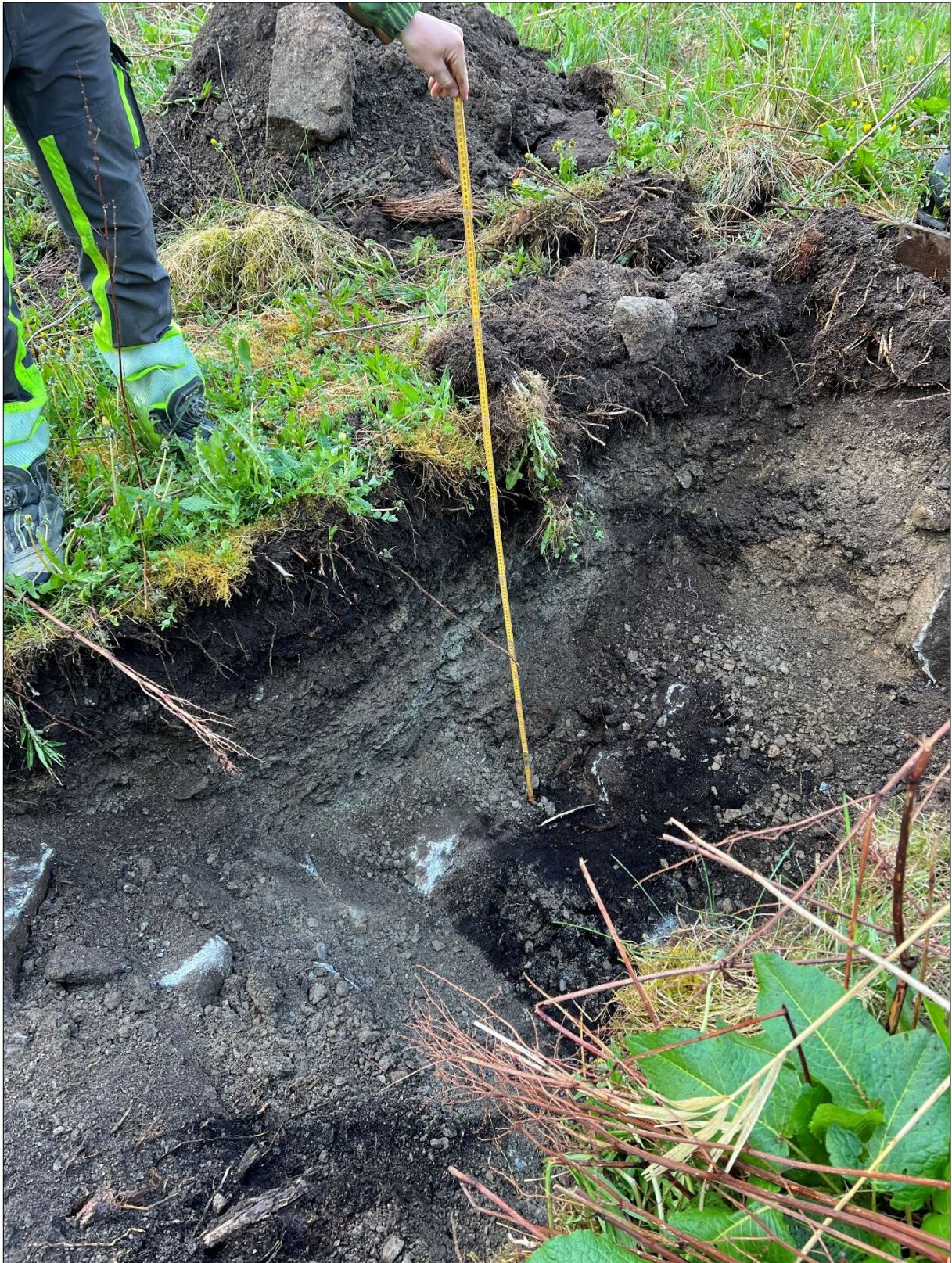
Figur 13: Foto fra gravepunkt 2. Myr/organisk materiale er påtruffet ved 1,2 m dybde. Foto: SGC.
