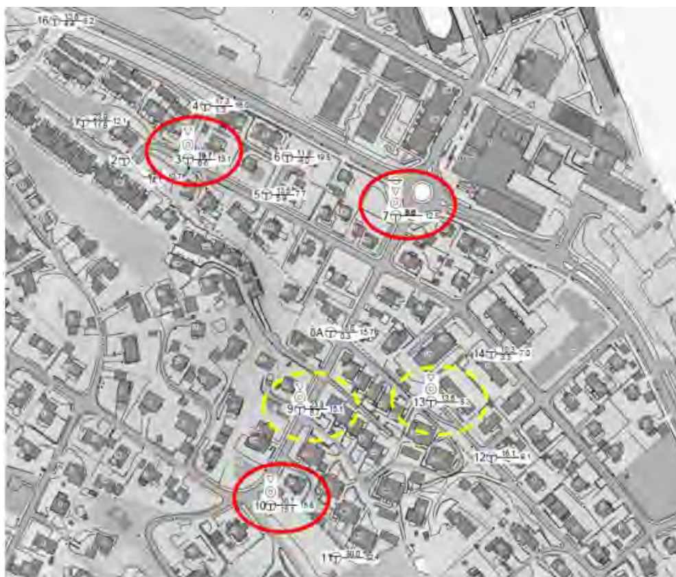
Figur 18. Utklipp fra borplan i rapport fra grunnundersøkelser. Prøveserier uthevet med runding, gul stippet angir funn av sprøbruddmateriale, rød hel runding angir funn av kvikkleire.
