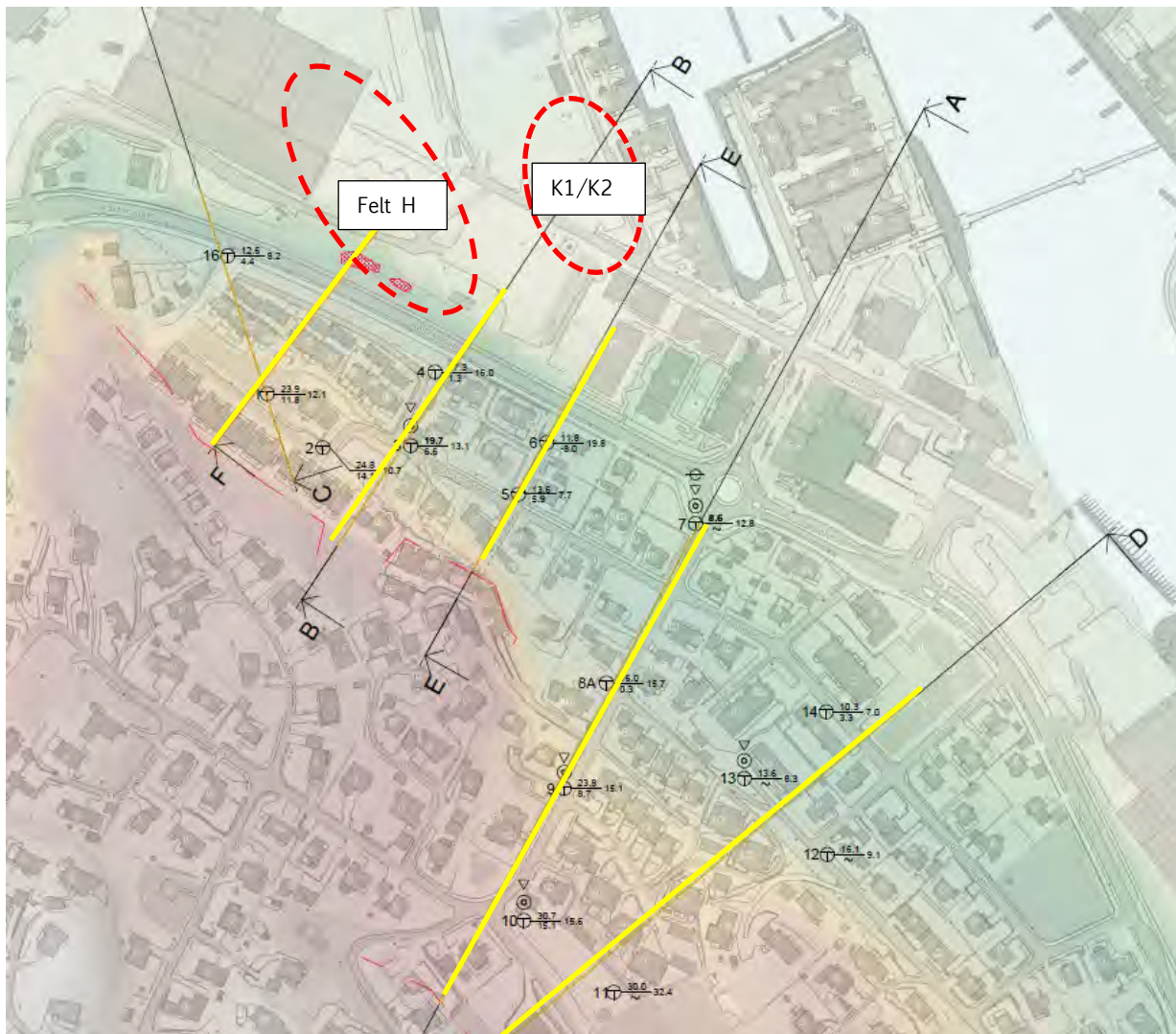
Figur 15. Utklipp fra borplan med profiler og angivelse av andel av profiler med helning brattere enn L = 15H i gult. Plassering av bygg K1/K2 og felt H er omtrentlig markert.
