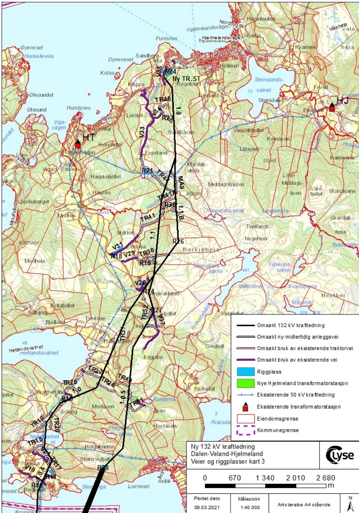
Figur 33: Kartutsnitt av ny 132 kV kraftledning mellom Årdalsfjorden og Hjelmeland transformatorstasjon. De omsøkte midlertidige bi-anlegg er vist og merket i henhold til tegnforklaringen. Kilde: Lyse Elnett, 2021.
