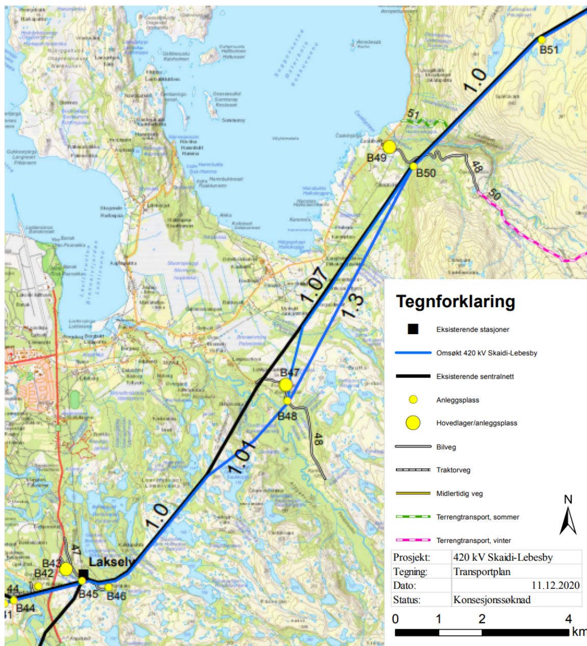
Figur 1-7: Traseen forbi Lakselv transformatorstasjon mot Časgil (ved punkt B50). Traseen til dagens 132 kV ledning er vist med svart strek. Alternativer 1.01, 1.3, og 1.07 for ny 420 kV ledning er vist med blå strek. Kilde: Statnetts søknad
