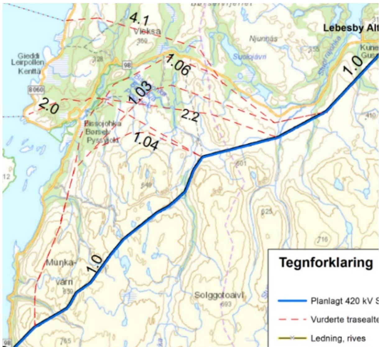
Figur 2-2: Vurderte traséalternativer 1.03, 1.04 og 1.06 nord for trasé 1.0, vist med stiplede røde linjer. Kilde: Statnetts søknad.
