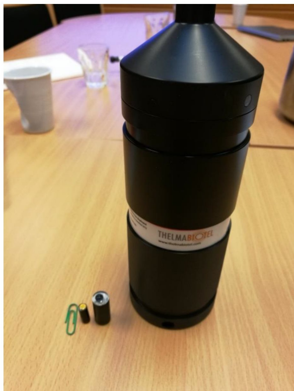
Foto: Privat. Sendere av forskjellige størrelser til venstre og mottaker til høyre. Binders er med for å sammenlikning av størrelse.
