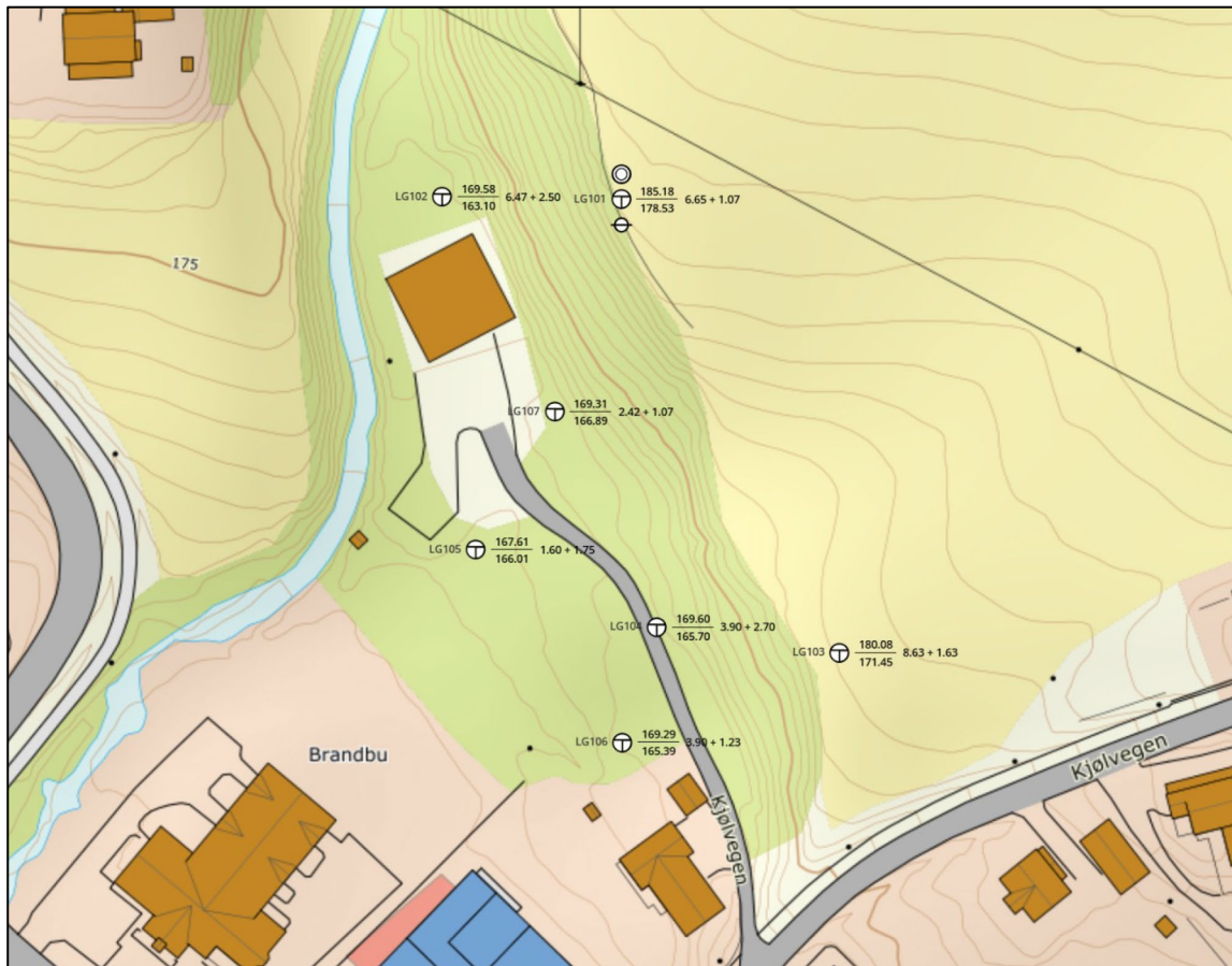
Figur 2.2 Situasjonsplan med utførte grunnundersøkelser fra ref. [5].
