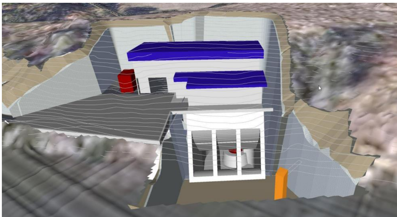
Figur 2-2. 3D modell av inntak og kraftstasjon
