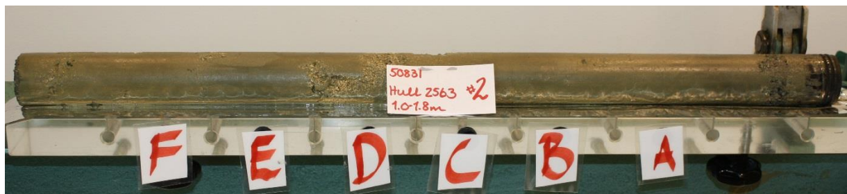
Bilde 3: Prøveserie 2563 del nr2. Siltig sandig leirig materiale innholdende korall
