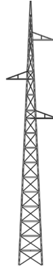
Tårnmast - selvbærende Aktuell for å redusere EMF
