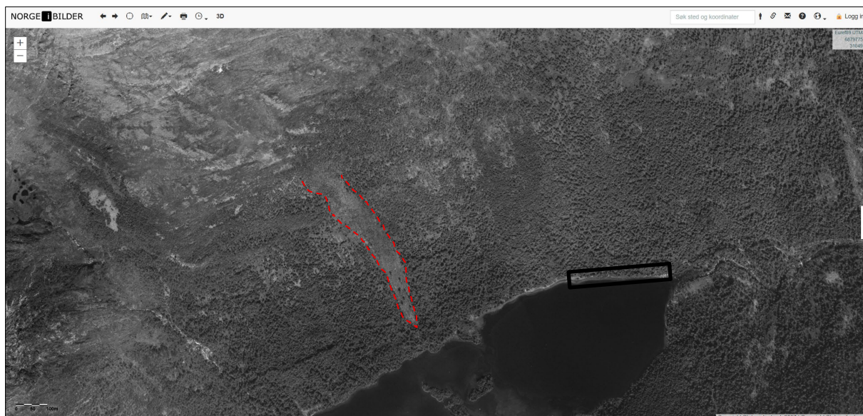
Figur 16: Flyfoto fra 1980 viser skredhendelse 400-500 m vest for kartlagt område. Kartlagt område er innenfor svart rektangel. Vertikalfoto: norgeibilder.no
