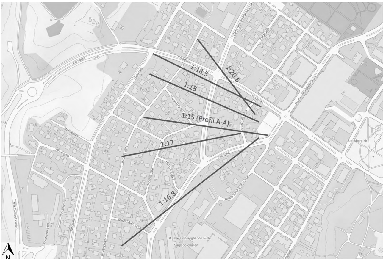
Figur 5-5: Oversiktstegning med profiler.
