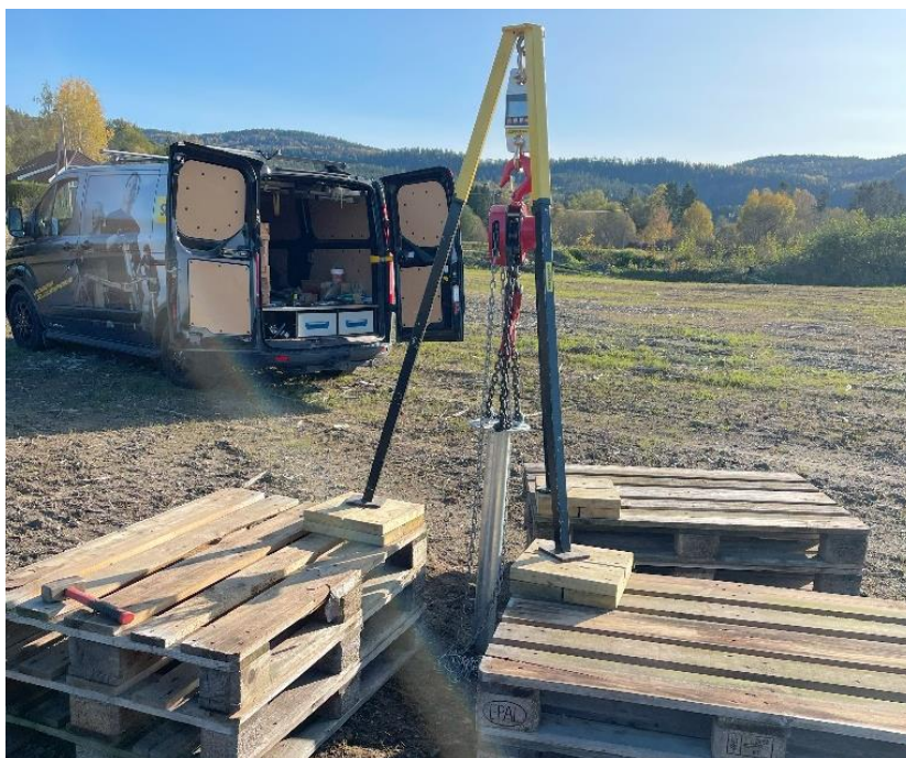
Bilde 6 Viser gjennomføringen av uttrekkstester
