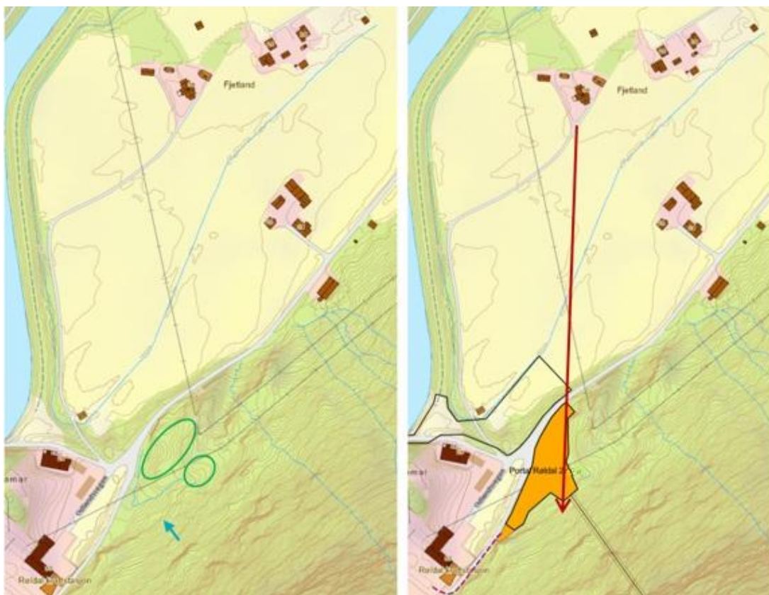
Figur 2-18 Det er viktig å ta hensyn til bekk og eksisterende landskapsformer i portalområdet. Dersom området planeres ut, vil portal og tilhørende skjæringer bli synlig fra bebyggelse, i tillegg til fra veien.
