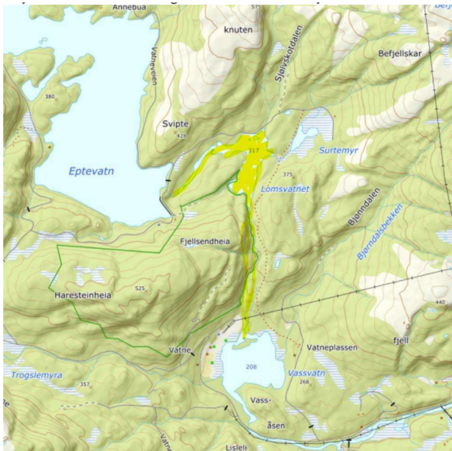
Figur 1. Tiltaksområdet ved dam Eptevatn. Delen av vassdraget som får redusert minstevannføring, mellom Eptevatn og Vassvatnet, er markert med gult. Fra søknaden side 3.
