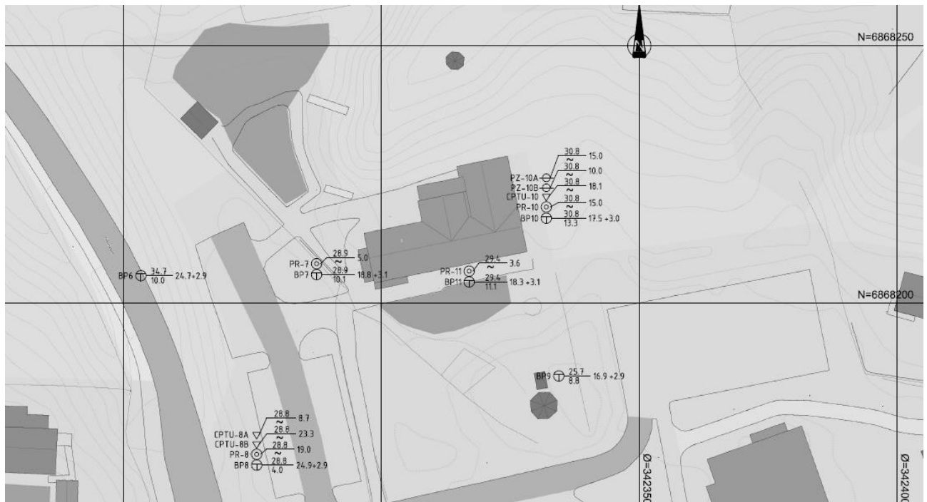
Figur 4-4: Utsnitt fra borplan for supplerende grunnundersøkelser for Gjerdane barnehage, tegning nr. 10228011-RIG-TEG-002.
