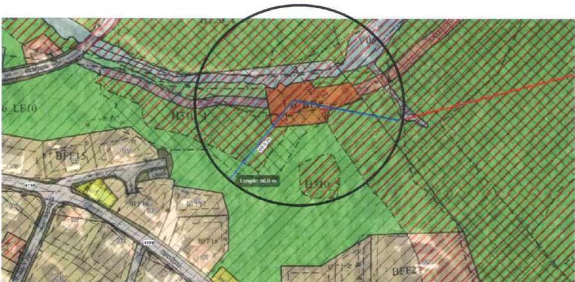
Figur 2 Kastsektor for mindre sprekk eller hull, 60 meter
