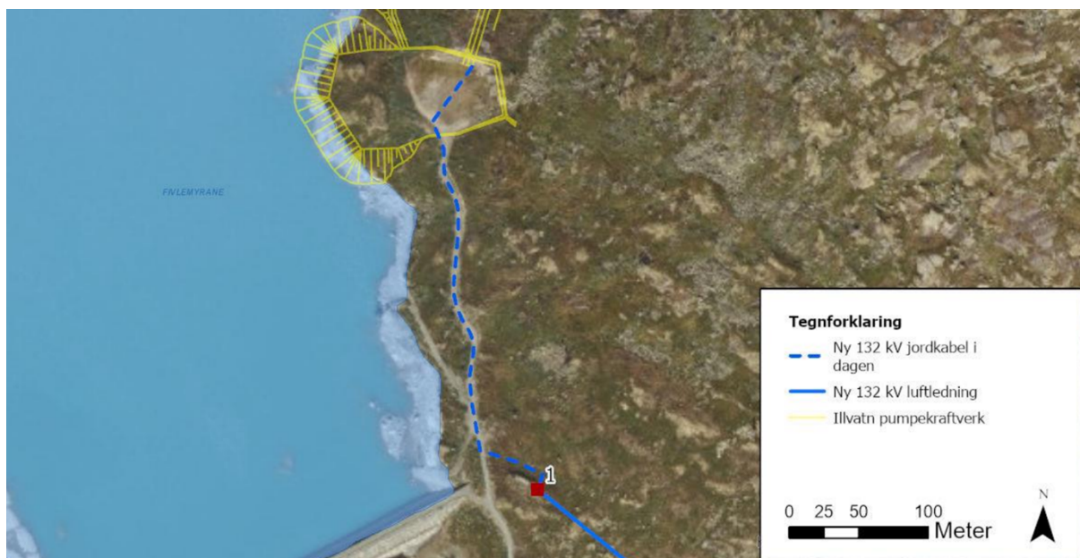
Figur 4 132 kV kabeltrasé til Illvatn pumpekraftverk (jordkabel i dagen betyr nedgravd kabel). Kilde: Hydros endringssøknad av juni 2024.
