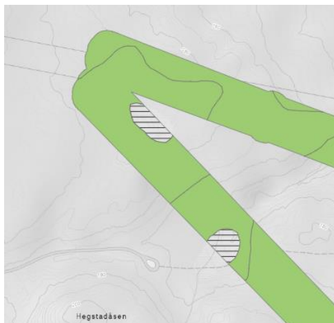
Figur 4-2 Utsnitt av Figur 4-3 viser ryddebeltet for omlagt sentralnettledning.
