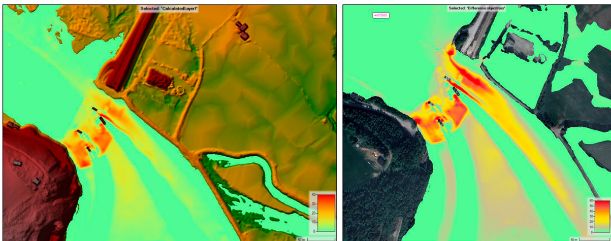
Figur 7: Endring i skjærspenning som følge av erosjonssikringstiltak for en middelflom (1300 m 3 /s) til venstre og dimensjonerende flom (2700 m 3 /s) til høyre. Lys grønn farge tilsier ingen endring, mørk rød viser endring på opp til 60 N/m 2 . Nordspissen av Gåsøya er helt i nederste bildekant.
