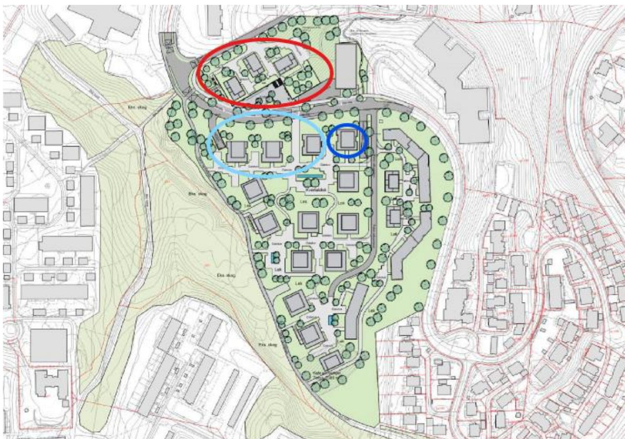
Figur 1-2. Steinan. Skisse som viser planlagt ny bebyggelse. Rød sirkel i figuren under indikerer grovbygg som er ferdig, innenfor turkis sirkel foregår det grunn- og betongarbeider. Innenfor den blå sirkelen i figuren jobbes det med forberedende arbeide
