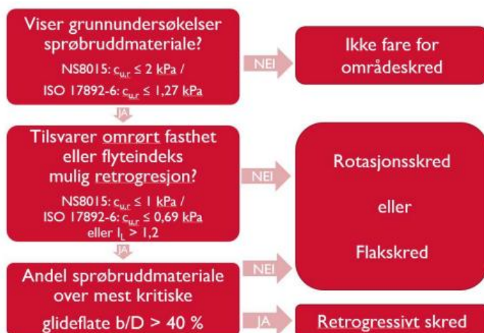
Figur 12: Flytskjema for vurdering av skredmekanisme. Figur 4.3 i NVE-veileder [1]
