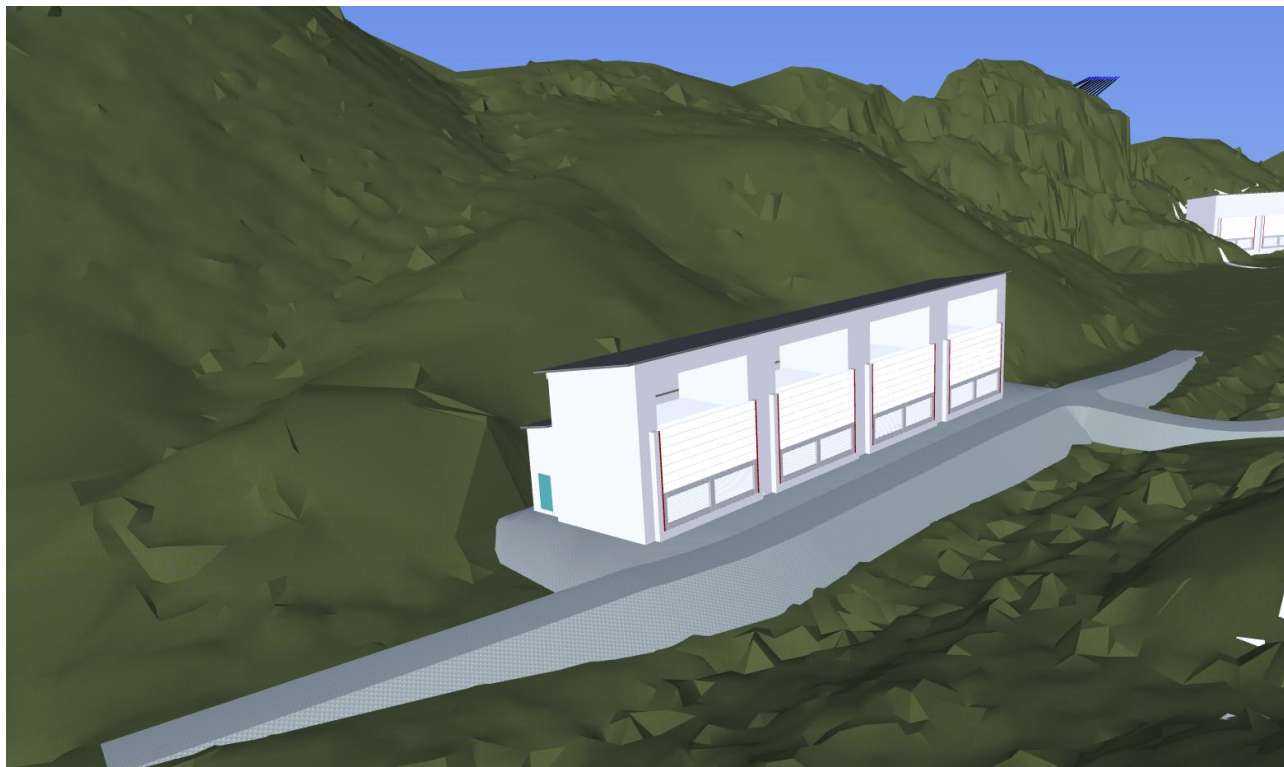
Figur 26: Skisse av motfylling og nytt transformatorbygg
