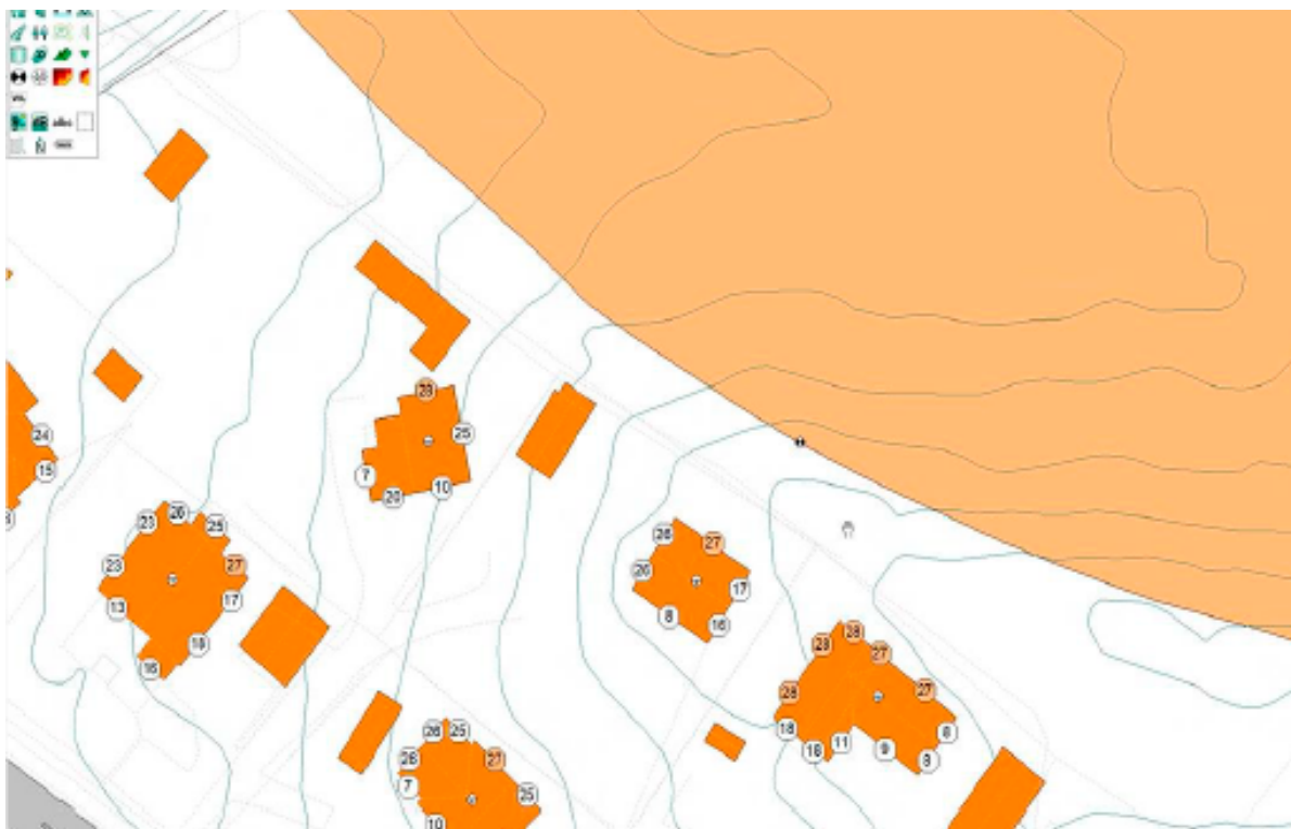
Figur 9: Støykart som viser at støynivået på fasaden på noen av de nærmeste boligene sør for omformerstasjonen vil være opp mot 28 dB når utluftingsristene er vendt mot sør. Kilde: Bane NORs e-post til NVE av 12. juni 2024.
