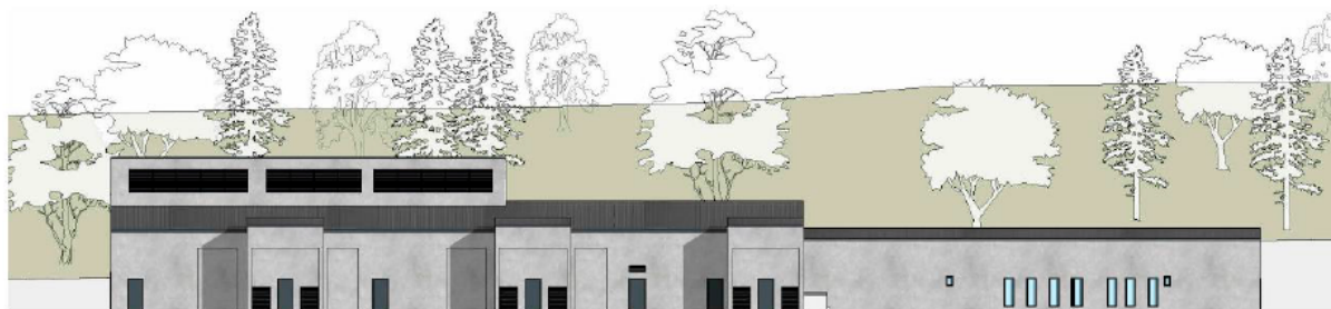
Figur 4: Fasaden på stasjonsbygget sett fra sør, med utluftingsrister vendt mot sør. Utluftingsristene er vist med vannrette svarte rektangler øverst til venstre på bygget. Kilde: Bane NORs søknad av 22. mars 2024.
