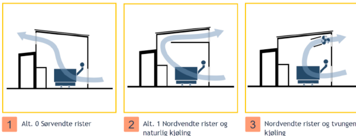
Figur 3: Lyseblå piler viser hvordan luftgjennomstrømningen skal foregå ved henholdsvis 1) sørvendte utluftingsrister med naturlig kjøling, 2) nordvendte utluftingsrister med naturlig kjøling og 3) nordvendte utluftingsrister med tvungen kjøling. Kilde: Bane NORs e-post til NVE av 12. juni 2024.
