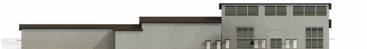
Figur 11: Fasaden på stasjonsbygget sett fra nord, med utluftingsrister vendt mot nord. Utluftingsristene er vist med svarte rektangler øverst til høyre på bygget. Kilde: Bane NORs søknad av 22. mars 2024.
