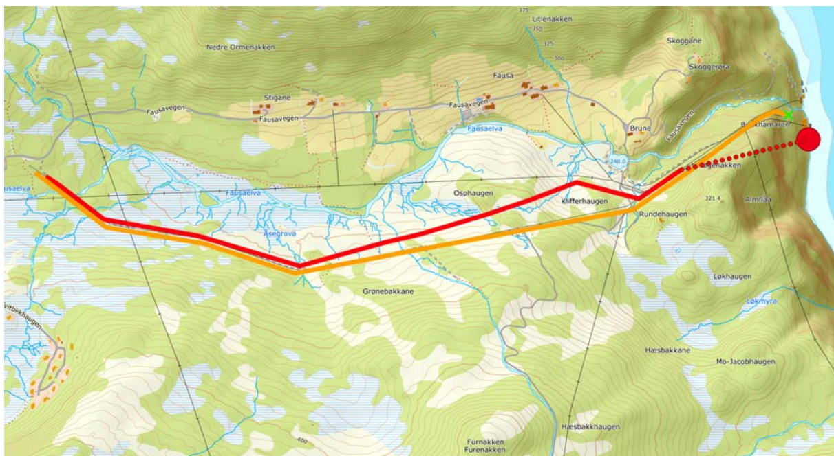
Figur 1. Ved raudt punkt vil tunellinnslaget til kraftverket vere. Raud line er planlagt nedgrave ny røyrledning, og stipla line er tunell. Oransje line viser der dagens røyrgate går oppe på terrenget.
