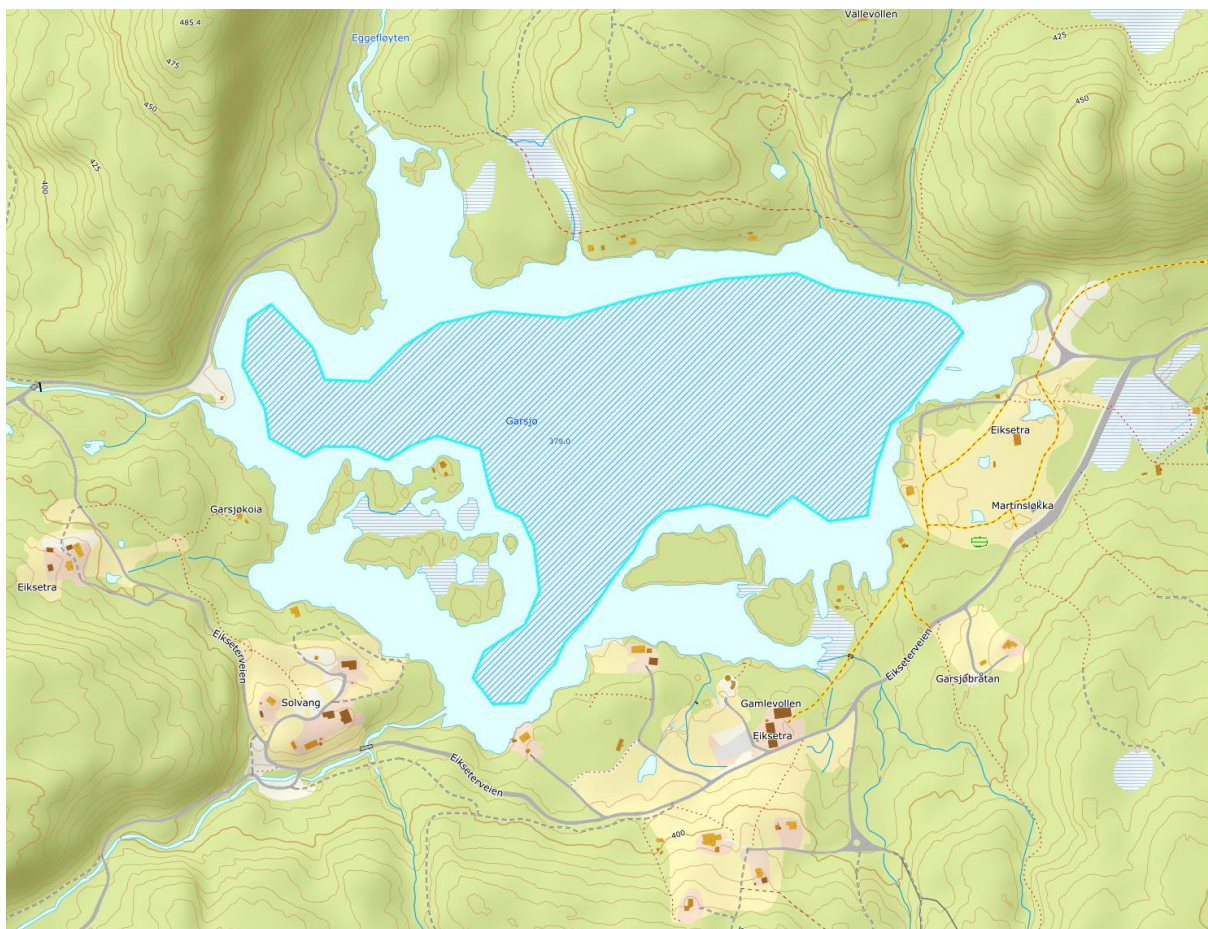
Figur 11: Vannspeil Garsjø ved 5 meter tapping. Utgangspunktet er dybdekartet fra figur 4.
