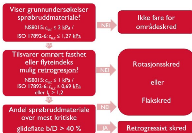
Figur 3.2 Flytskjema for vurdering av aktuell skredmekanisme [1].
