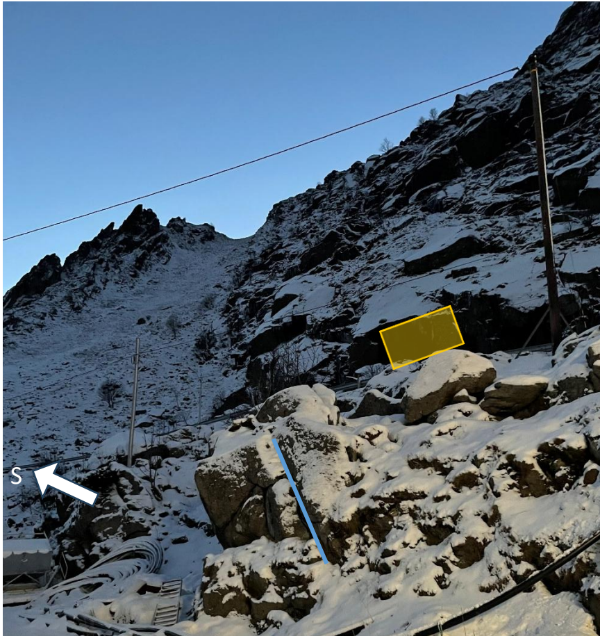
Figur 5: Blå strek indikerer foliasjonsplan med fall mot nord, mens gul flate foliasjonsplan med fall mot vest.
