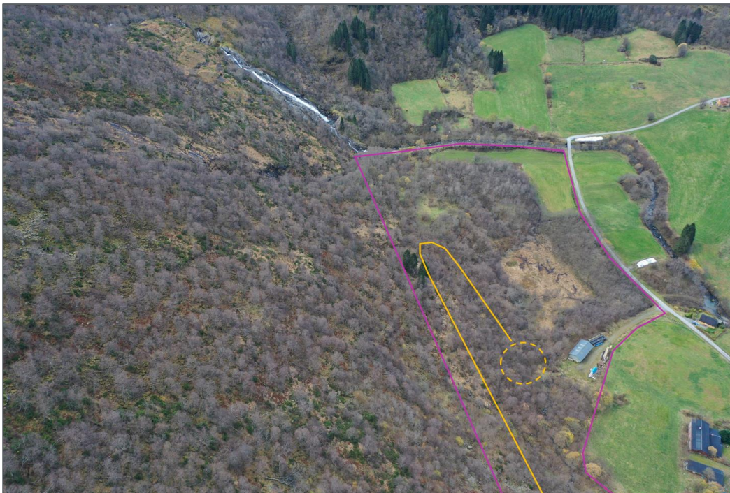
Figur 35 Dronebilde av nedre del av fjellsiden og kartleggingsområdet. Lilla linje viser ca. plassering av kartleggingsområdet, oransje stiplet sirkel planlagt påhuggsområde og oransje linje planlagt ny vegtrase. Bilde tatt mot sørvest.
