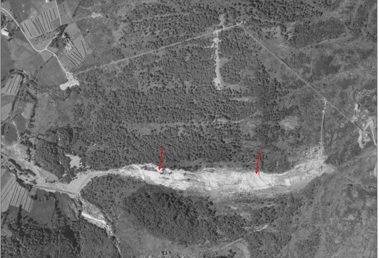
Figur 19 Flyfoto fra 1961 viser løsmasseskred i fjellsiden som oppstod som følge av en ikke-planlagt utskylling gjennom et tverrslag som dro med seg steintippen [5].
