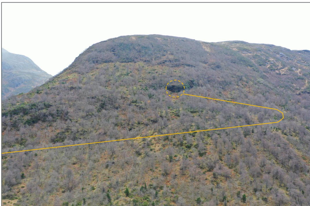
Figur 41 Dronebilde av fjellsiden. Ca. plassering av mulig påhuggsområde for tunnel vises med oransje stiplest sirkel og planlagt vegtrase med oransje linje. Bilde tatt mot sørøst.
