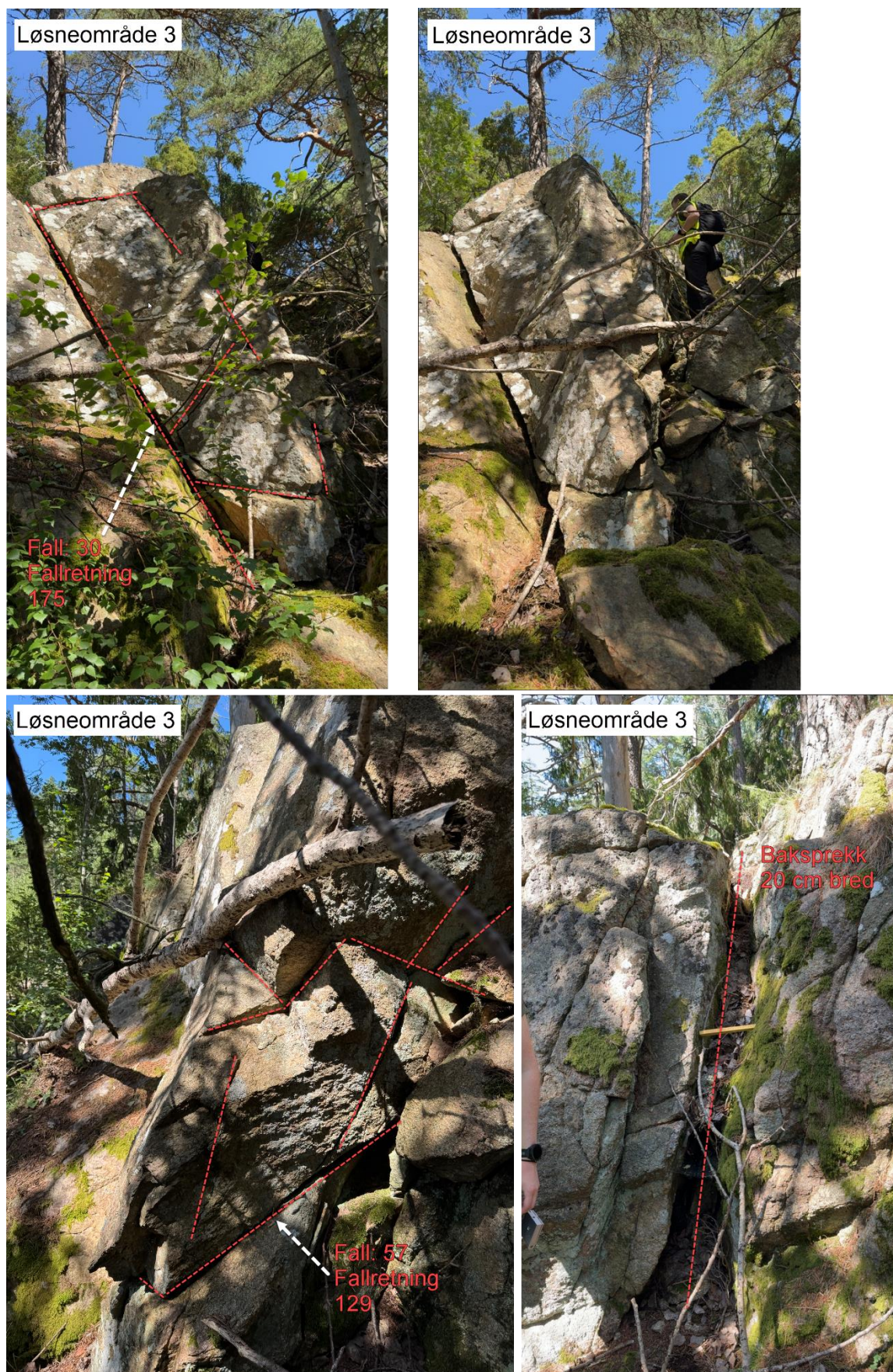
Figur 4-3: Løsneområde 3. Stor kile som kan potensielt mobiliseres og treffe kartleggingsområde. Baksprekken er 20 cm bred.
