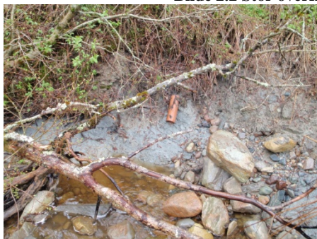
Bilde 2.3 Utgliding i yttersving i bekk langs sonegrense, leire så vidt synlig
