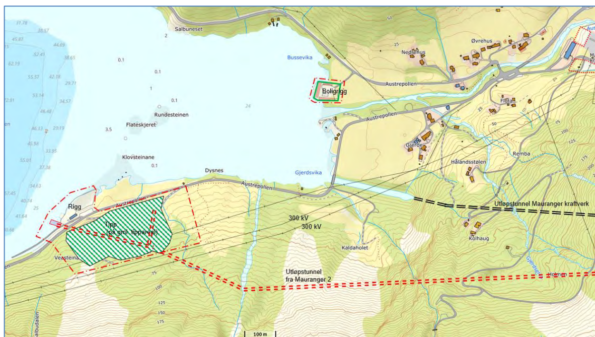
Figur 2-17. Bolligrigg og utløp i Austrepollen. Tippområde er skravert.
