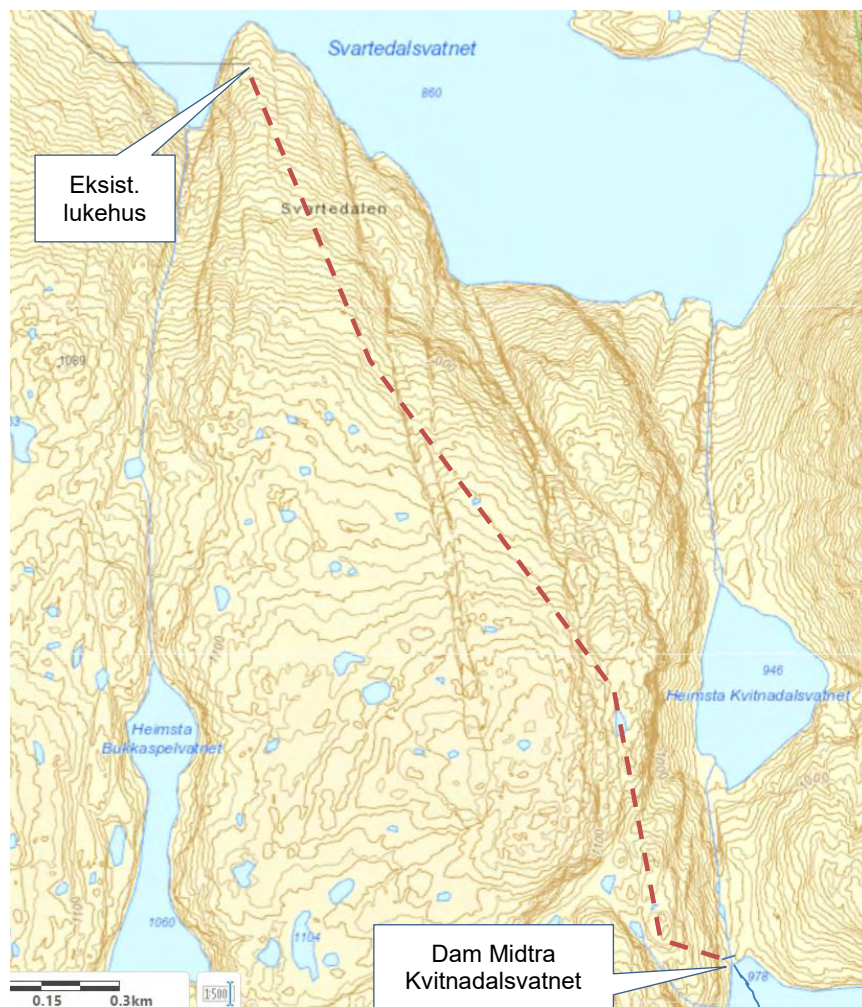
Figur 2-21. Foreslått trase for ny 22 kV luftlinje mellom lukehus ved Svartedalvatnet og dam Midtra Kvitnadalsvatnet. 2,1 km og videre 0,7 km i kabel gjennom Midtra Kvitnadalsvatnet.
