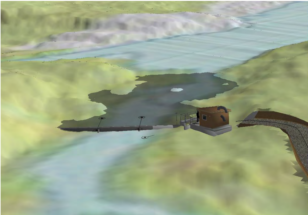
Figur 7 Perspektiv av inntakskonstruksjon og terrengtilpasning
