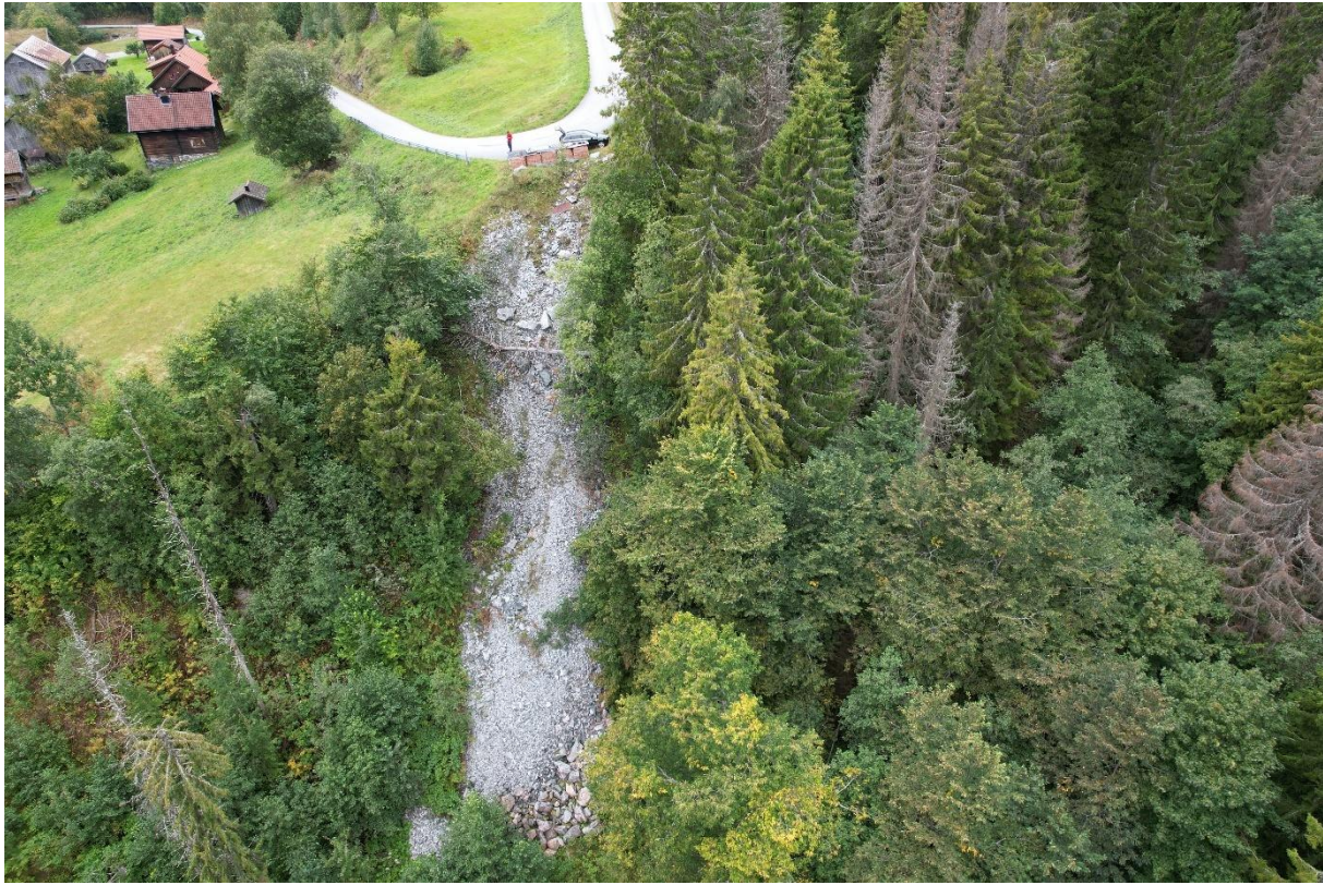
Figur 9: Antatt skred som tilsvarer historikken til ID 3 observert under befaring. Lokal utglidning ned mot Grobudalen.
