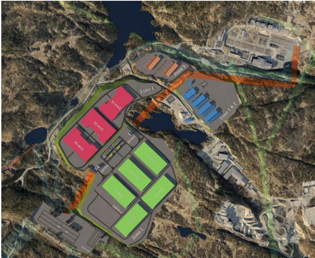
Figur 4: De to omsøkte luftledningene vist i oransje. Den ene fra Stemmen TS til EHVS 1B og den andre fra Kristiansand TS til EHVS 2A.
