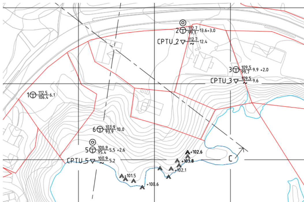
Figur 3: Utsnitt fra borplan, tegning 21101-001, med dybder til berg.
