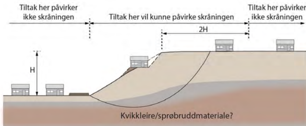
Figur 17: Prinsippsnitt som viser når et tiltak kan vurderes som utenfor influensområdet til en skråning. Hentet fra kvikkleireveilederen [3].
