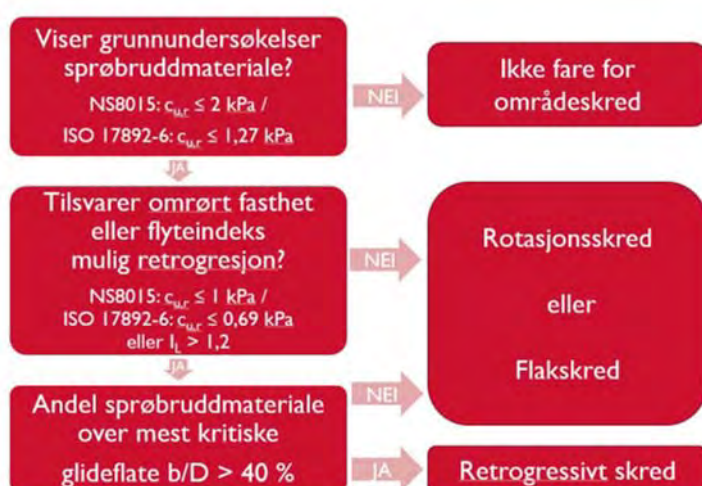
Figur 14: Flytskjema for vurdering av aktuell skredmekanisme [3].
