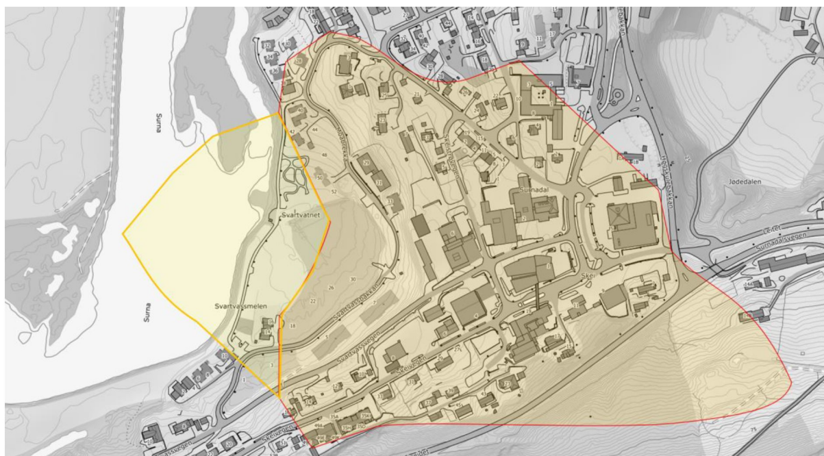
Figur 15: Vurdert løsne og utløpsområde. Utløpsområder marker i gult, løsneområde markert i rødt.
