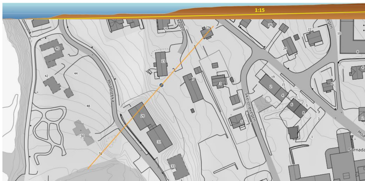
Figur 13: Bilde med profil fra høydedata.no, høydeforskjell i profilet er ca. H = 20 meter. Profilet ved boring som avkrefter sprøbruddmateriale.
