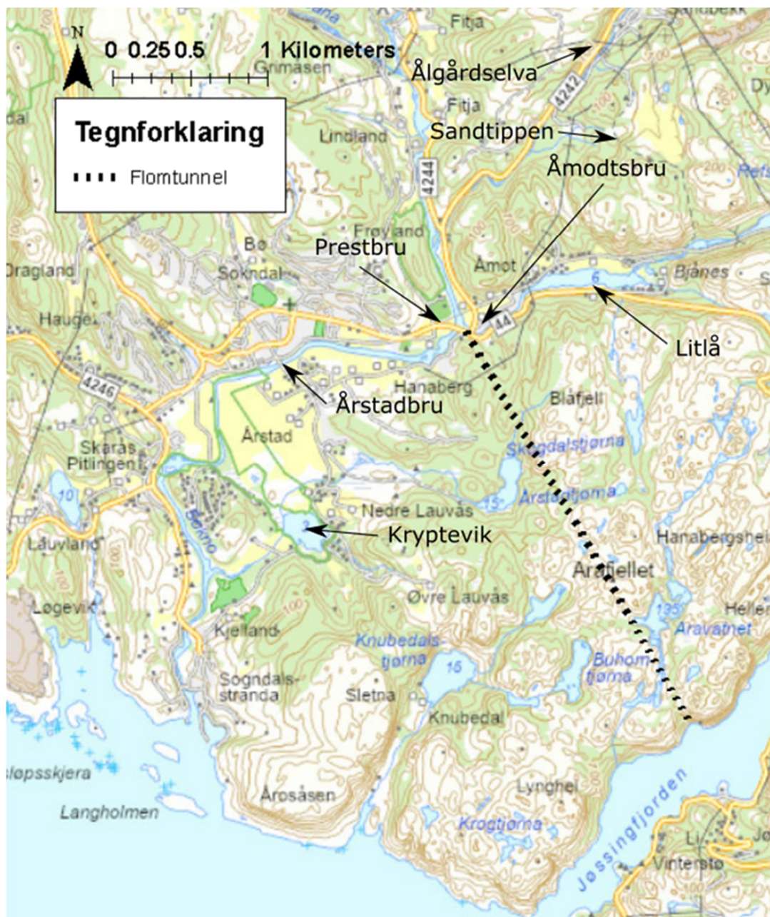
Figur 3-1. Kartet viser traseen for tunnelen fra Sokna ved Åmotshølen til Jøssingfjord.
