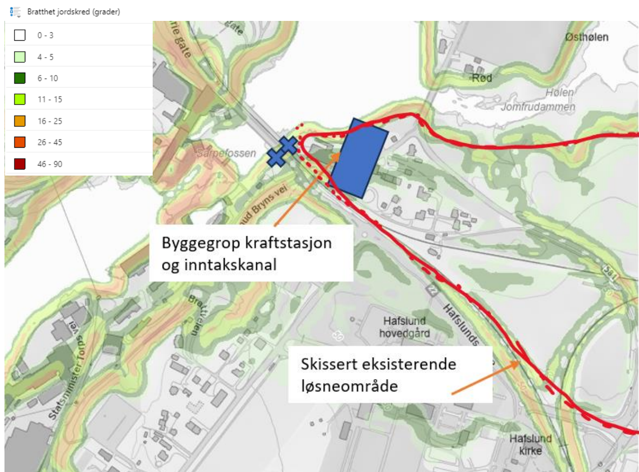
Figur 4-4 Bratthetskart fra NVE. Skråningshelning 1:15 tilsvarer 3,8 grader. Det vil si at alle skråninger med farge har potensiale for å være et løснеområde. Blå kryss indikerer berg i dagen.
