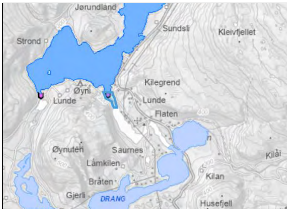
Figur 1-1. Oversiktskart som viser Glomsdam kraftverk med utløpskanal markert med blå skravur, kraftverk i sør, inntakskanal i nord. Til venstre på kartet ligger utløp ved Russdam. Kilde: NVE atlas.
