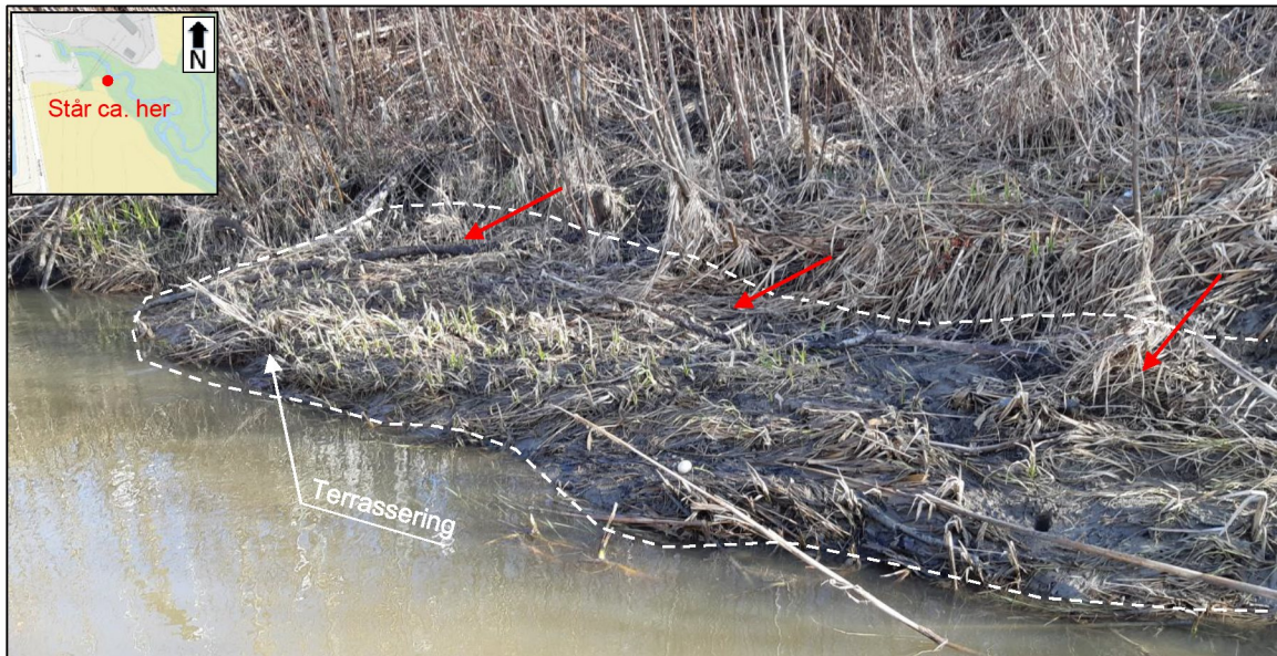
Figur 4.11: Står syd for bekken og tar bilde mot nord, som viser terrassering av løsmasser i bunn bekk og indikerer bevegelse i skråningen (Fra befaring 09.04.2021)
