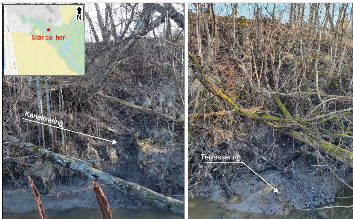
Figur 4.13: Står nede i bekken og tar bilde mot nord, som viser skråstilte trær som indikerer bevegelse i massene (overflatesig). Det er også pågående kanalisering (utgraving) med terrassering i bunn skråning (Fra befaring 09.04.2021)
