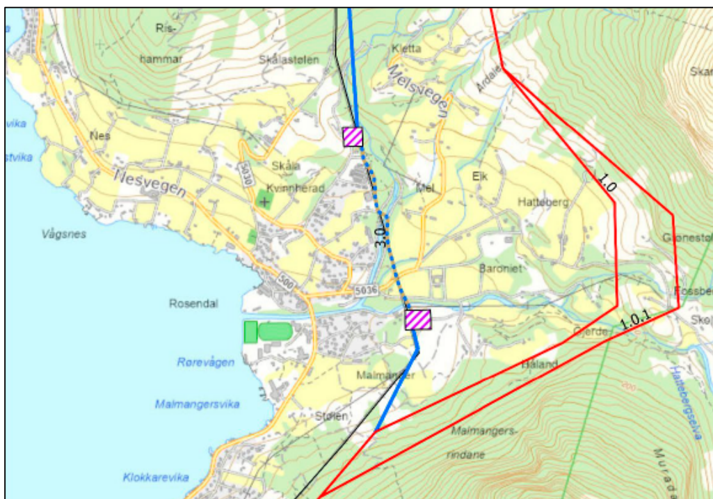
Kart 3: Kartet viser meldte alternativer gjennom Rosendal. Jordkabelalternativ 3.0 er markert med stiplet strek. Foreslått plassering for muffehus er markert med firkanter med rosa skraver. Kilde: Statnetts melding av 31. mai 2024.
