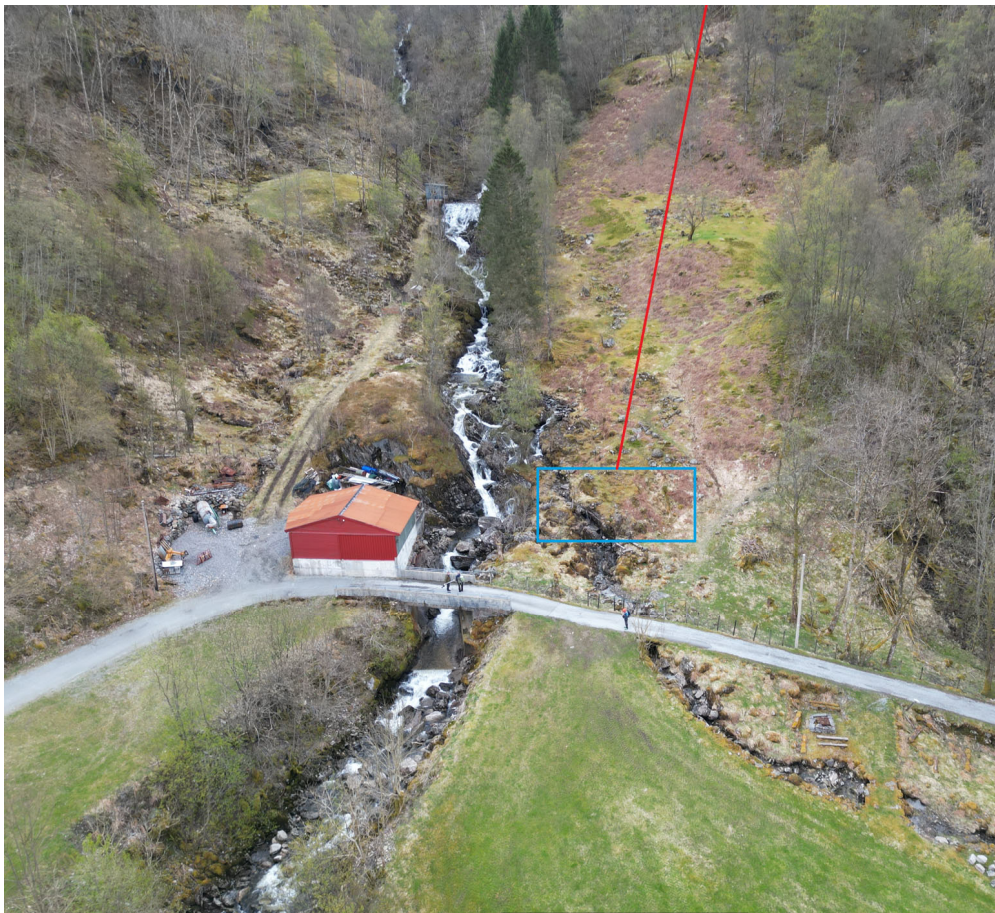
Figur 4 Bilete frå kraftstasjonsområde. Blå linje illustrerer plassering kraftstasjon. Raud linje illustrerer plassering røyrgate
