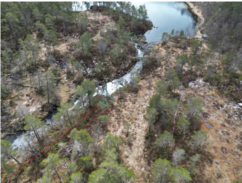
Figur 3 Bilete inntaksområdet teke frå nedstrams side. Blå linje illustrerer plassering inntaksbygg og dammen. Raud linje illustrerer røyrgata.
