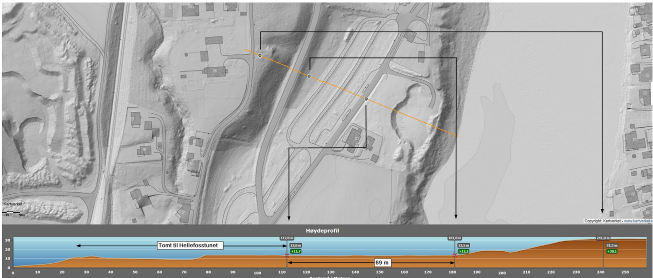
Figur 4.2 Profil av terrenget fra Drammenselva til topp av skråning nordvest for tomten
