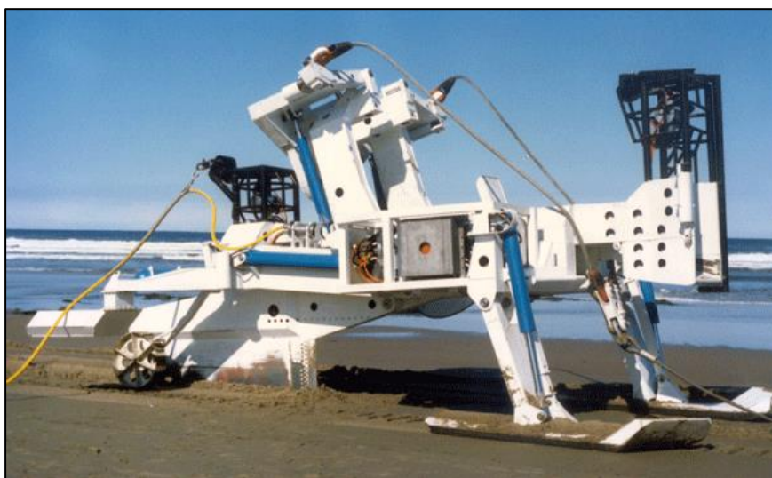
Figur 7. Undervannsfarkost for kabelinstallasjon ved pløying. Kilde: kis-orca.eu
