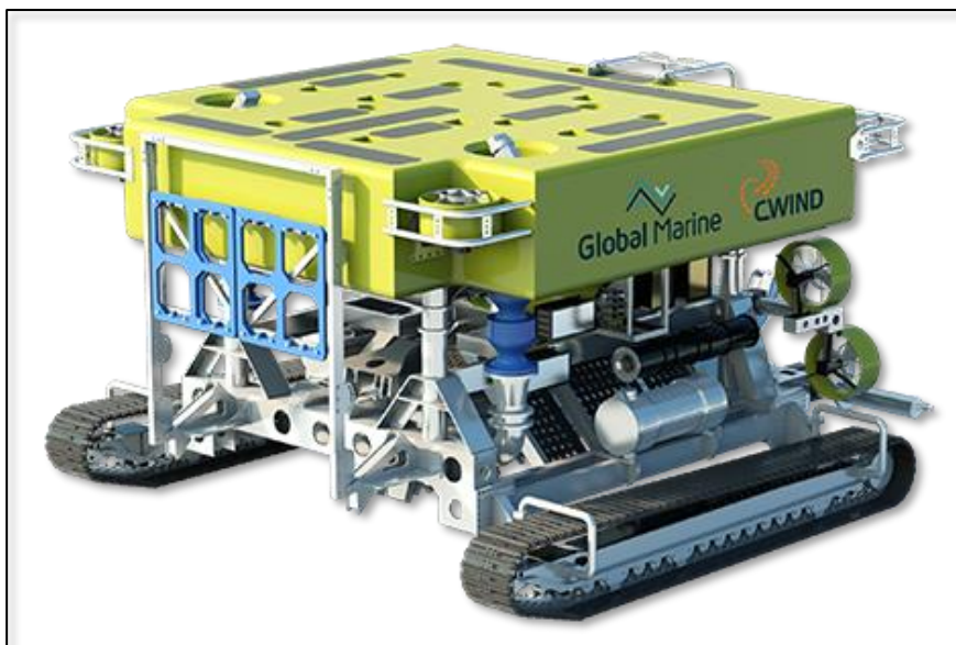
Figur 6. Undervannsfarkost for grøfting av kabel.. Kilde: global-marine.co.uk
